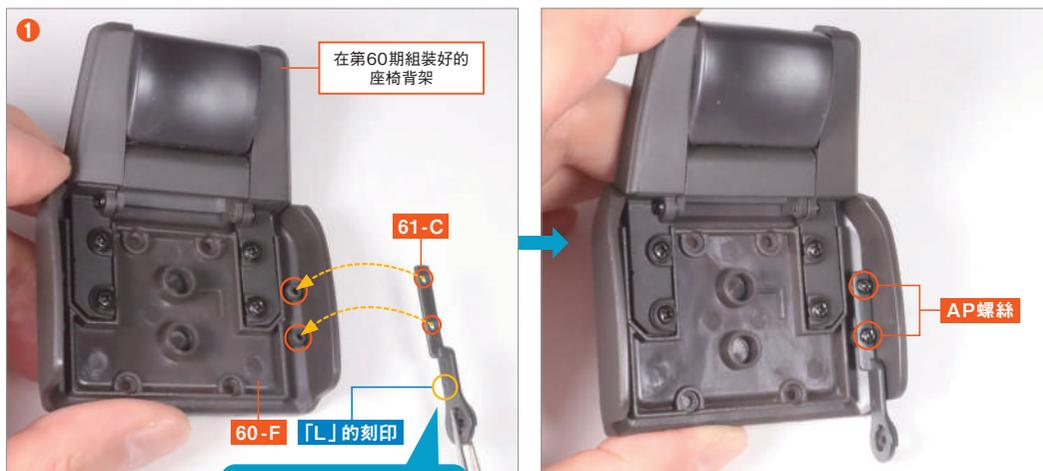
首先，備妥在第60期組裝完成的座椅背架。將斜躺架 (L) 61-C 的兩個螺絲孔與副駕駛座椅背護板 60-F 上右側的兩個螺絲孔突起部分對齊，並使用 AP螺絲 固定。
